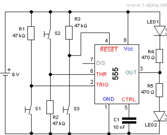
A **RESET** ( törlés ) bemenet, amely a 4-es lábon vezérelhető, közvetlenül az RS flip-flop törlő bemenetéhez van kötve. Ha az **S3** nyomógombot megnyomjuk, **RESET** bemenet feszültségszintje alacsony lesz, ekkor az RS flip-flop alaphelyzetbe kerül, az **OUT** kimenet pedig alacsony szintre billen, **LED1** világít.
