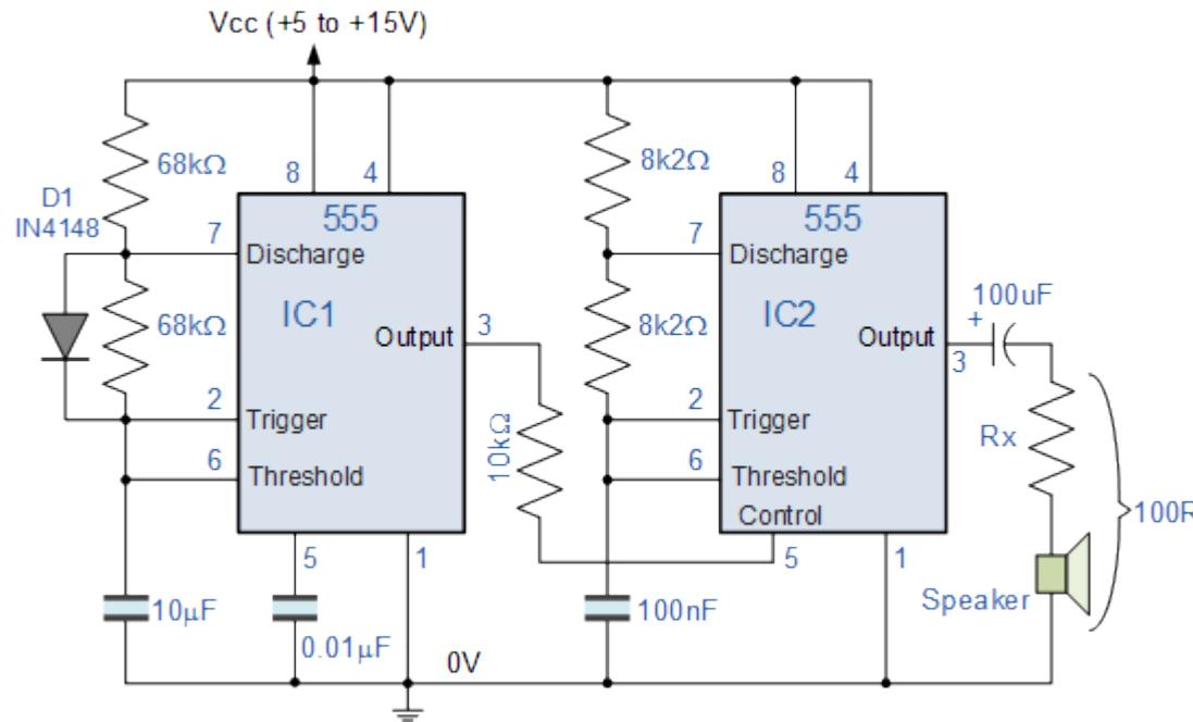
Két NE555 IC-t használunk fel. Az első fokozat egy 50 % kitöltésű, kisfrekvenciás négyzetjel generátor, ami a második fokozat (egy hangfrekvenciás astabil multivibrátor) visszabillenési szintjét, ezáltal a hang frekvenciáját változtatja.
