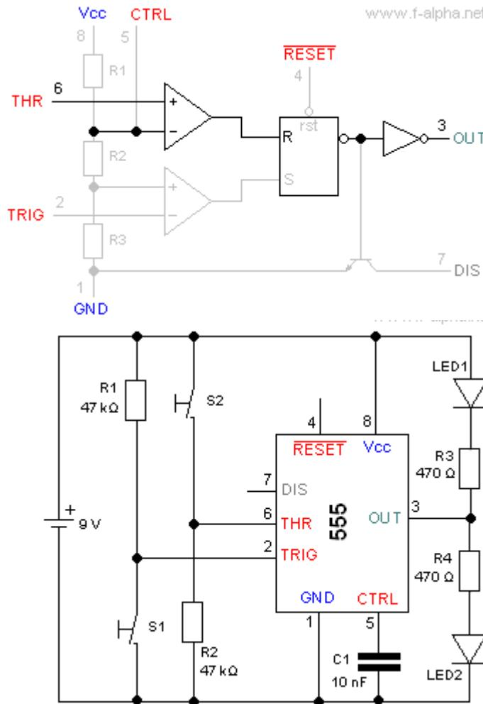
A **THRESHOLD** (küszöbszint) bemenet egy komparátor pozitív bemenetére van kötve. A komparátor másik bemenete a  $VCC \cdot 2/3$  pontra csatlakozik.
