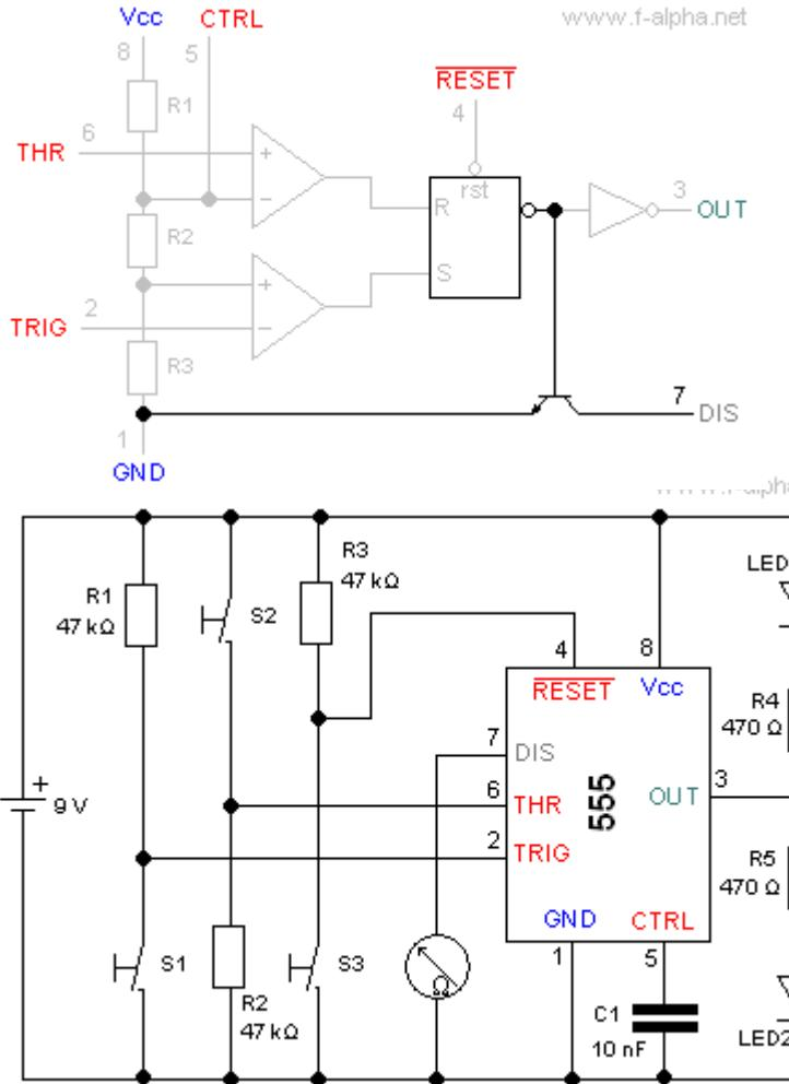
A **DISCHARGE** (kisütés) kimenet, ami az NE555 7-es lába, egy tranzisztor kollektorához van kötve (nyitott kollektoros kimenet). A tranzisztor bázisa az RS flip-flop invertált kimenetére csatlakozik. Amikor az RS flip-flop alaphelyzetbe kerül, a tranzisztor vezet. Ha az RS flip-flop aktív állapotba billen (triggerelés után), akkor pedig a tranzisztor lezár (nem vezet).
